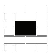
SLEEVE FITS INTO 1 BRICK WIDE BY 2 BRICK HIGH CAVITY
